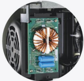
วงจรกรองสัญญาณรบกวน แยกออกจากแผงวงจรหลัก
