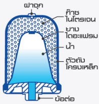
โครมสร้างถังแรงดันก๊าซไนโตรเจน
